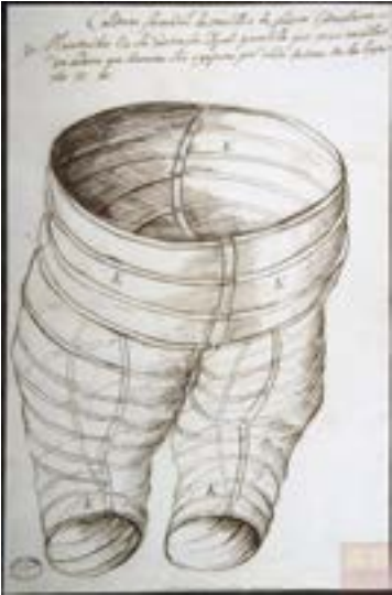
5. La sezione “bacino e gambe” della “Maquina Hydroandrica” di Durand. (segnatura: MP-Ingenios,251)
