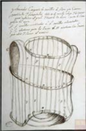
4. La struttura metallica della sezione “torace” della “Maquina Hydroandrica” di Durand. (segnatura: MP-Ingenios,250)
