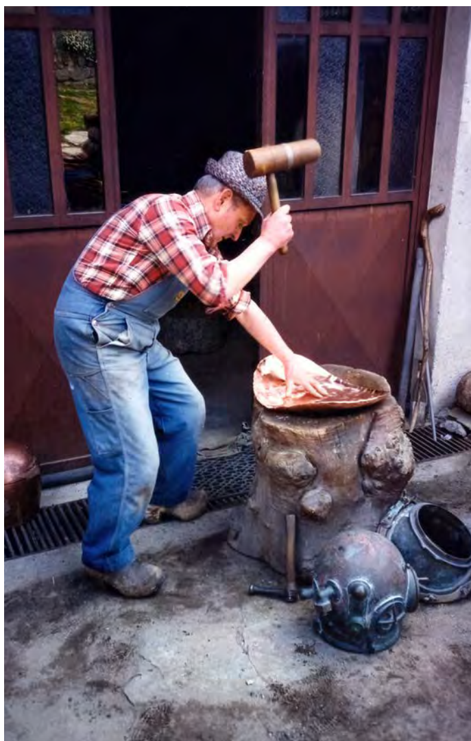
Tarrone imbutisce la lastra del collare con un mazzuolo sul ciocco
