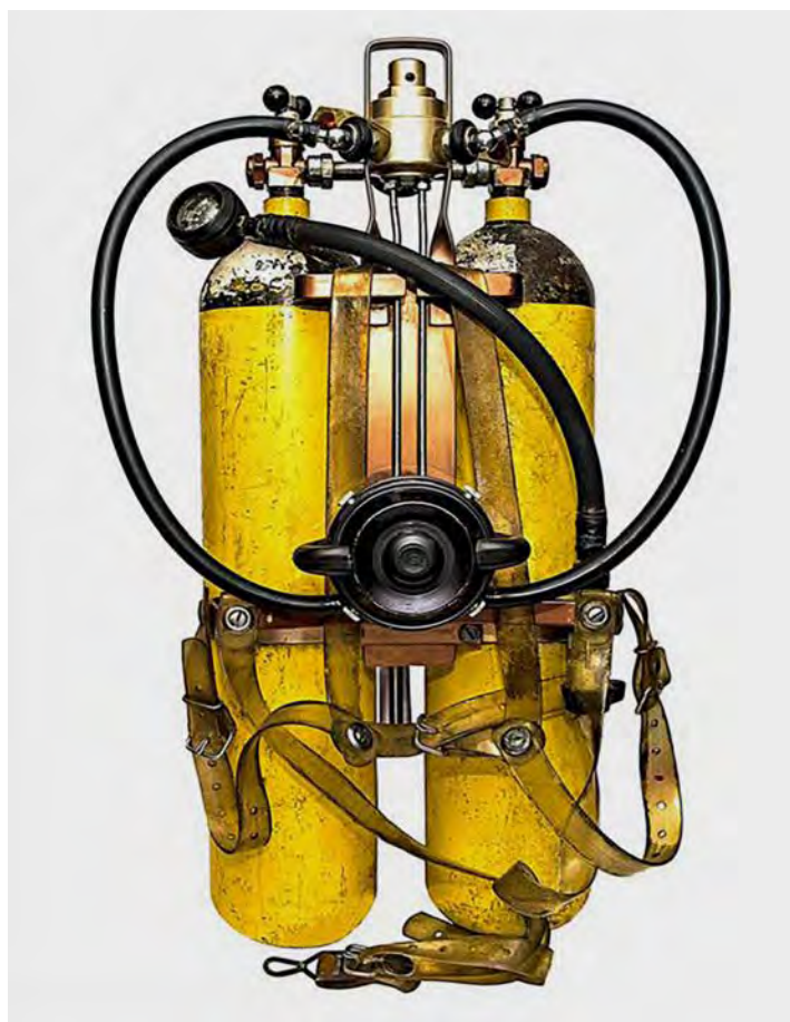
Autorespiratore AGA-RT bistadio con riserva semiautomatica e manometro a frusta, anno 1957 (Raccolta Luigi Fabbri)
