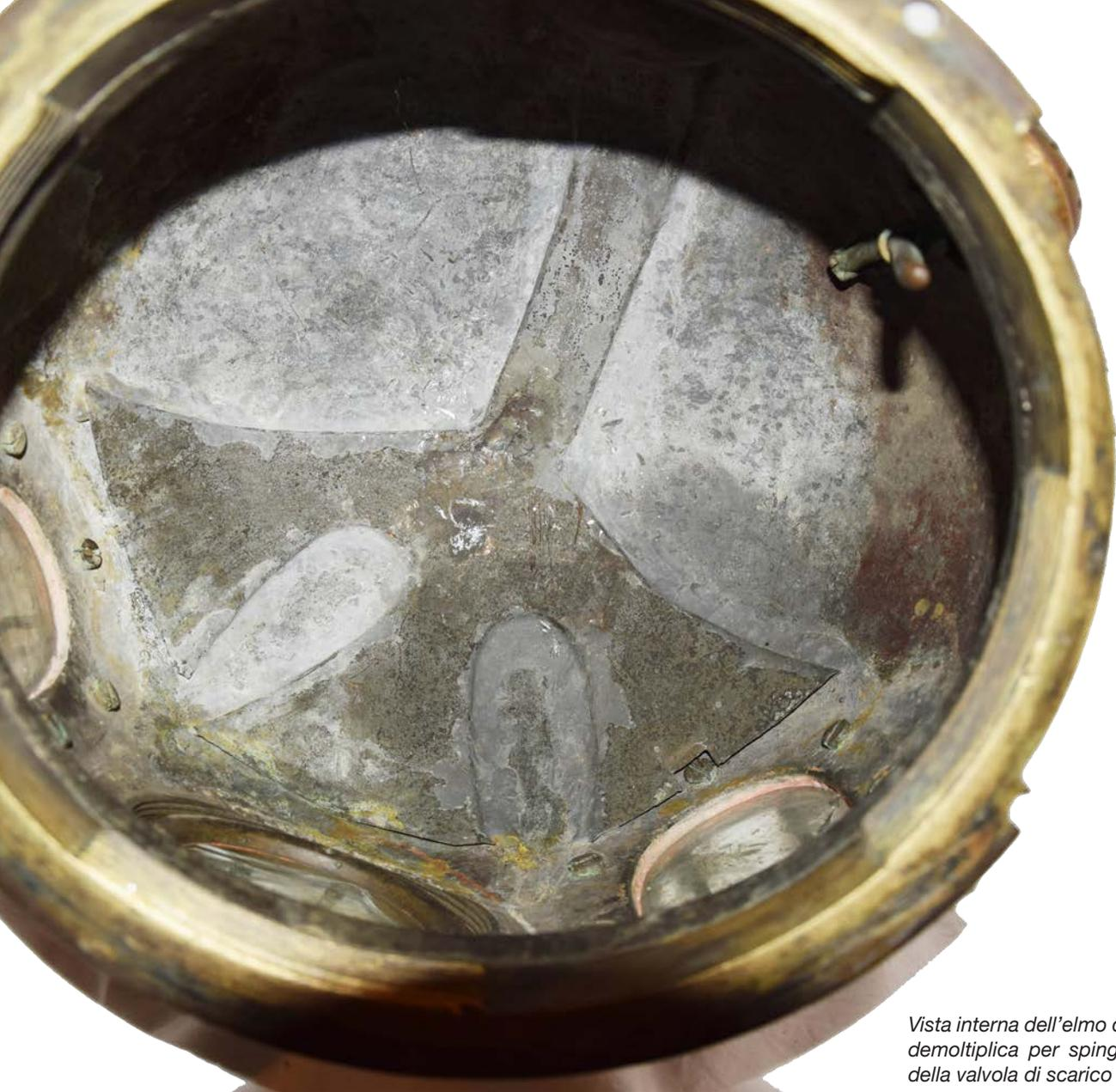
*Vista interna dell'elmo con la leva di demoltiplica per spingere il fungo della valvola di scarico*
