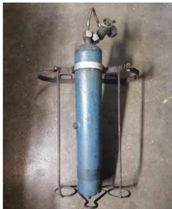
*Vista della zona rubinetteria e del dispositivo automatico di riserva nella versione monobombola dell'autorespiratore Tricheco (collezione Cesare Valle)*
