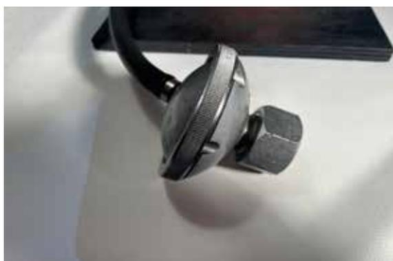
*Vista del primo stadio riduttore di pressione dell'autorespiratore Tricheco senza il cilindro di accumulo dell'aria a bassa pressione (collezione Maurizio Balducci)*
