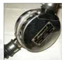
*Fig. 2 - Erogatore Salvas Acquasub: vista della scatola di erogazione e dell'etichetta*
