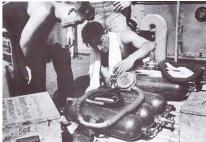
Fig. 9 -Una delle prime foto dell'autorespiratore CG45 con apparato tribombola e boccaglio metallico. Sulla sinistra si può notare la cassa in legno che conteneva l'apparato Cousteau-Gagnan. (da "La plongée autonome" di Claude Robinet e Luc Guillou, Marines édition, 1999)
