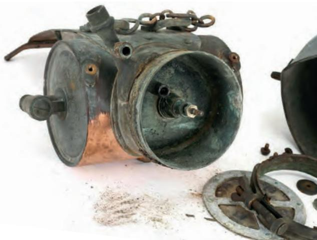
*Il casco Flohr prima del restauro. Le finestre erano rotte, il gancio per il regolatore e la valvola del regolatore erano stati rimossi, l'attacco di immissione dell'aria era stato segato e il pettorale era piegato (Foto Philip Nathansen).*
