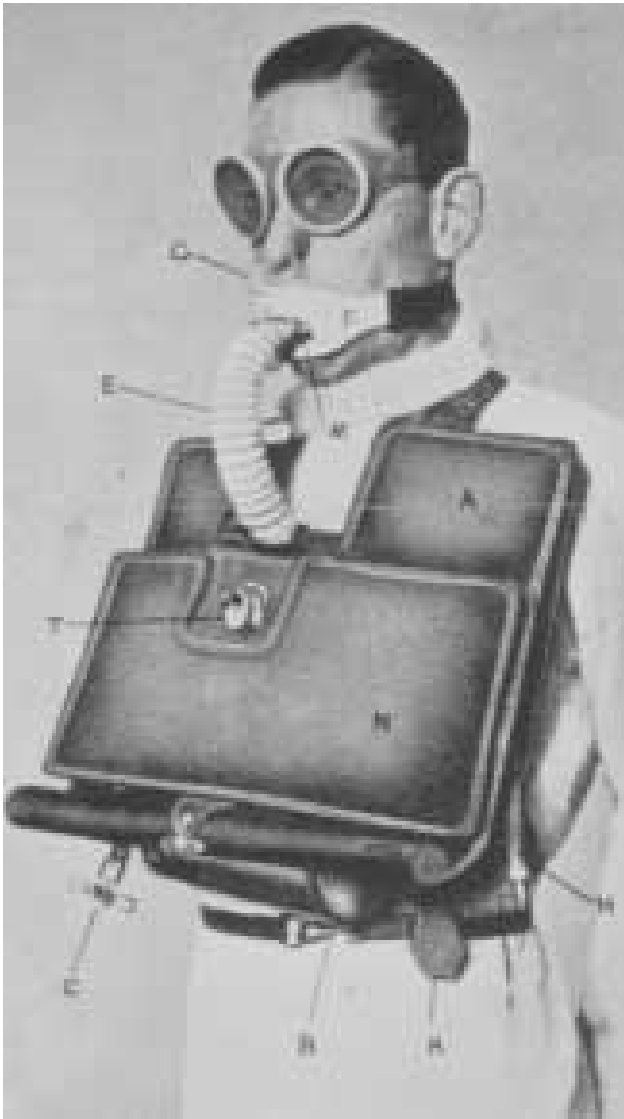
7 - anni 1928-32 - Gli occhiali in dotazione all'ARO Davis per l'uscita in emergenza dai sommergibili. Si nota nella parte bassa del sacco polmone il telo che, tenuto disteso, avrebbe rallentato la velocità di risalita (da Deep Diving and submarine operations , 1935)
