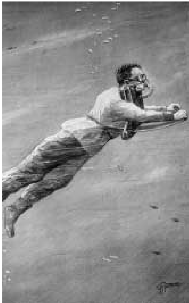
Fig.6 – Il "Davis submarine escape apparatus" (apparecchio Davis di sfuggita dai sommergibili) che fu adottato anche dalla Marina Italiana per i propri sommergibili. Questo ARO possedeva una valvola di sovrappressione nel sacco ed un telo estensibile per rallentare la velocità della risalita in emergenza. (da "Deep Diving and Submarine Operations – 1935)
