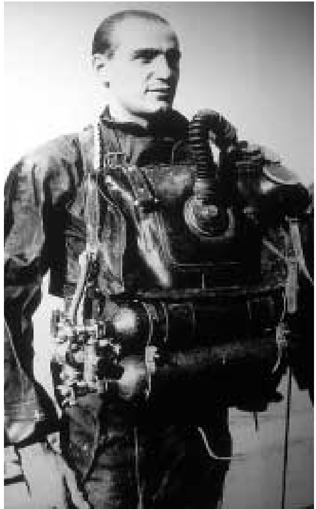
Fig.9 - Un incursore della MMI, pilota di "maiale" con un ARO Pirelli a grande autonomia, dotato di due bombole d'ossigeno (Museo Nazionale delle Attività Subacquee).
