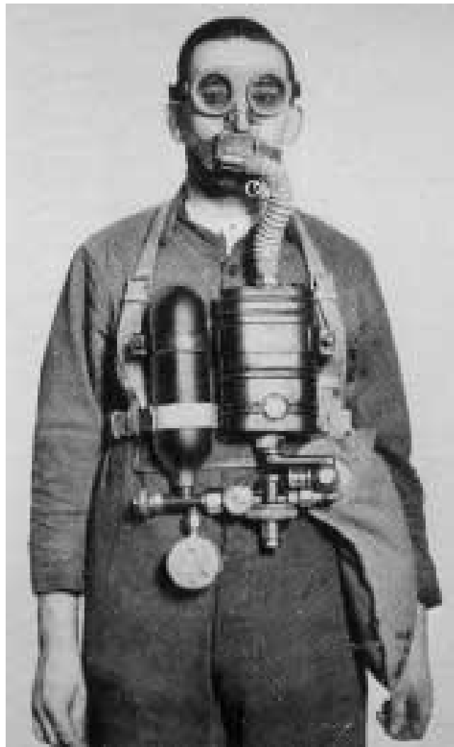
Fig.4 - Il "Salvus" realizzato dalla Siebe, Gorman & Co. assieme al "Proto" nei primi anni del 1900 ed adottati dalle forze armate di UK, USA e dai loro alleati per operazioni in ambienti tossici. (da "Deep Diving and Submarine Operations - 1935)
