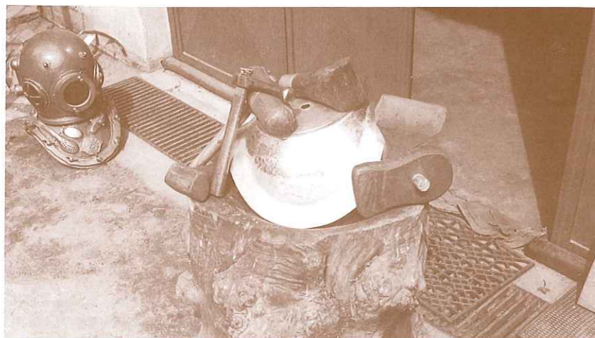
Lavorazione del collare ed alcuni martelli impiegati nella costruzione.
